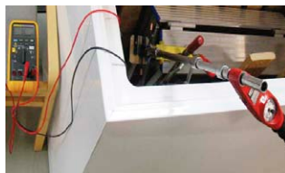
Испытания на монтаж при пониженной температуре
