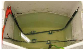
Диэлектрические испытания в воде
