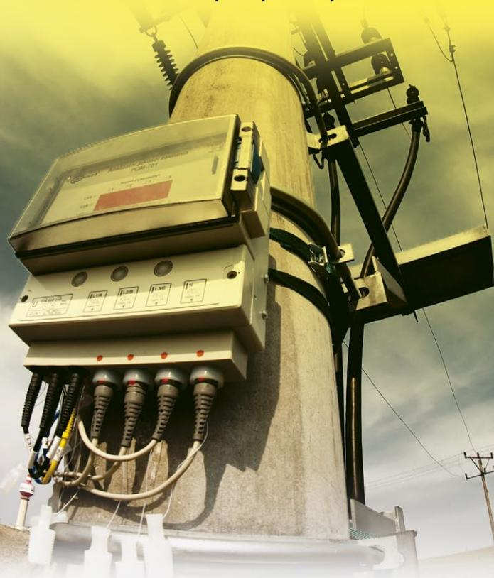
**PQM-701** разработан для проведения регистрации и анализа основных параметров качества электрической энергии в сетях с номинальными частотами 50/60 Гц согласно: ГОСТ Р 51317.4.30-2008 (МЭК 61000-4-30:2008) и ГОСТ Р 51317.4.7-2008 (МЭК 61000-4-7:2002), EN 50160:2008.
