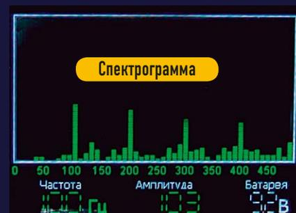
Основная частота полезного сигнала      Уровень сигнала      Напряжение батареи
